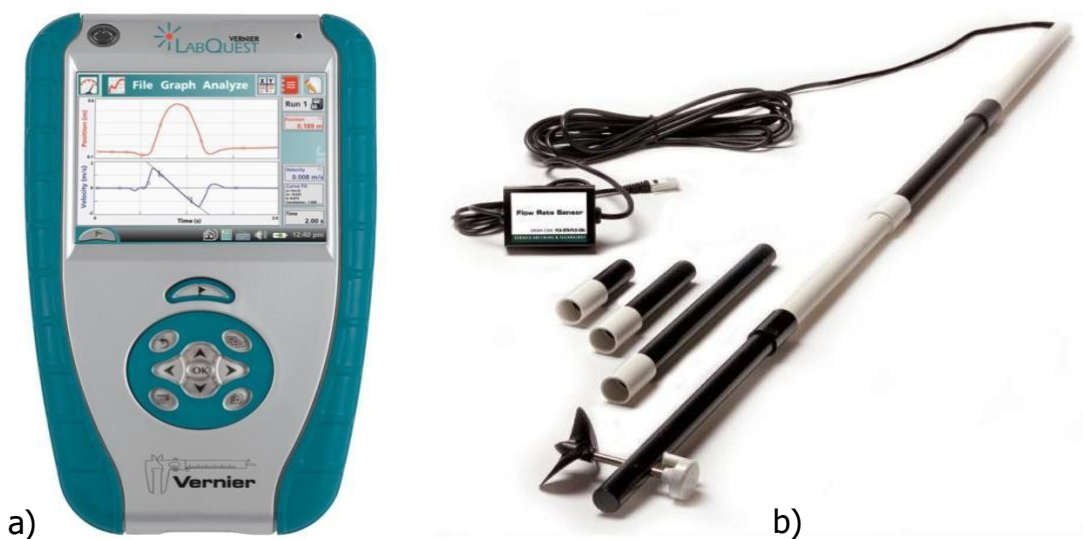
Figura 11: Foto e një instrumenti matës shpejtësie LabQuest. a) Kompjuteri; b) matësi i rrymës
