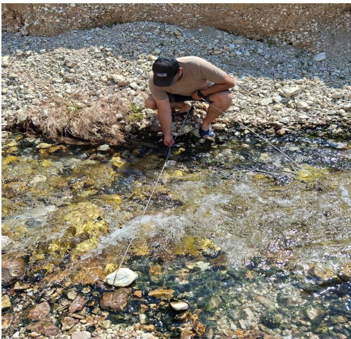
Figura 10: Demonstrimi i metodës shpejtësi-sipërfaqe. Matja e sipërfaqes së profilit të seksionit të lumit © A. Lala
